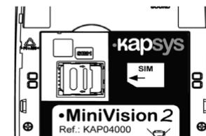
3. Inserte la batería colocando la sección inferior primero, con las almohadillas de conexión en la parte inferior derecha, luego coloque la parte delantera hacia abajo para hacer clic en ella.
